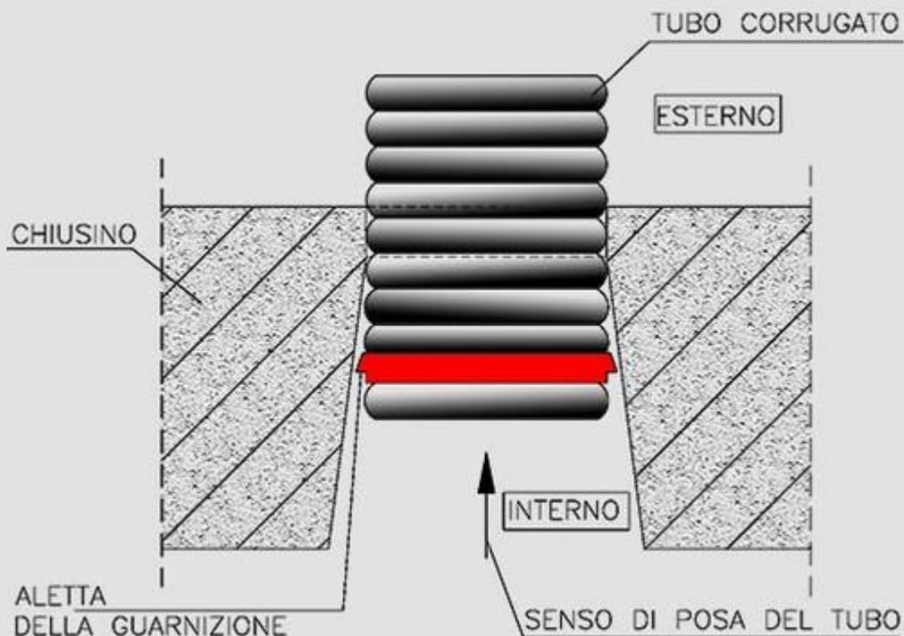
Infilandolo dall'interno all'esterno, facendolo incastrare con l'aiuto di una tavola di legno spessa, appoggiata all'estremità del tubo e battendo con una mazzetta per far incastrare bene la guarnizione dentro il foro nel cemento.
