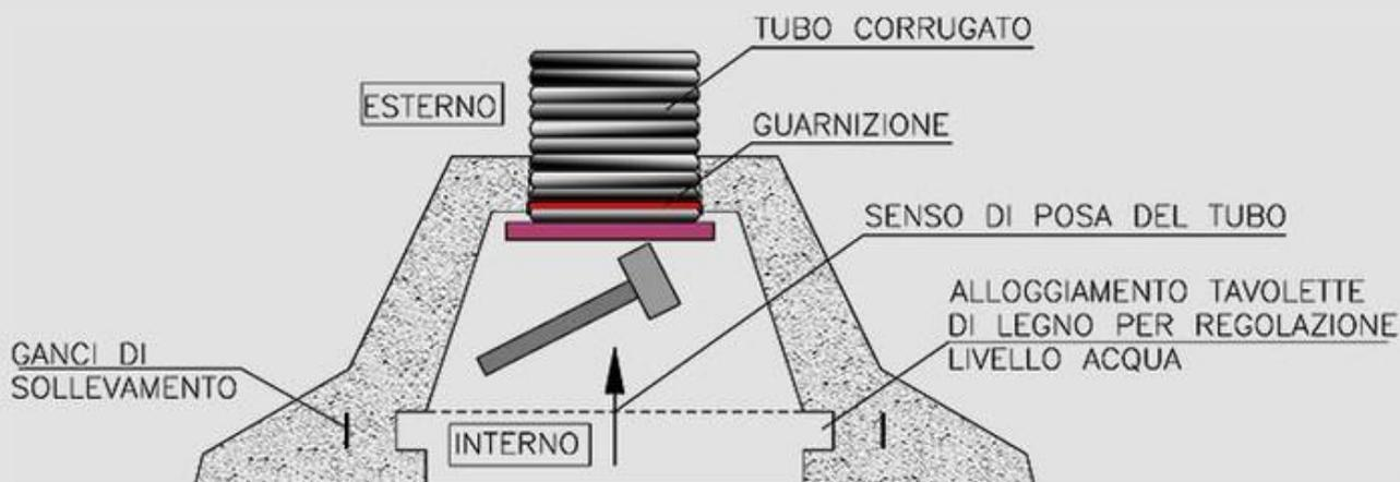
E' necessario tenere sempre il tubo posizionato a 90° rispetto la bocchetta; se necessita dare pendenza al tubo, inclinare la bocchetta
