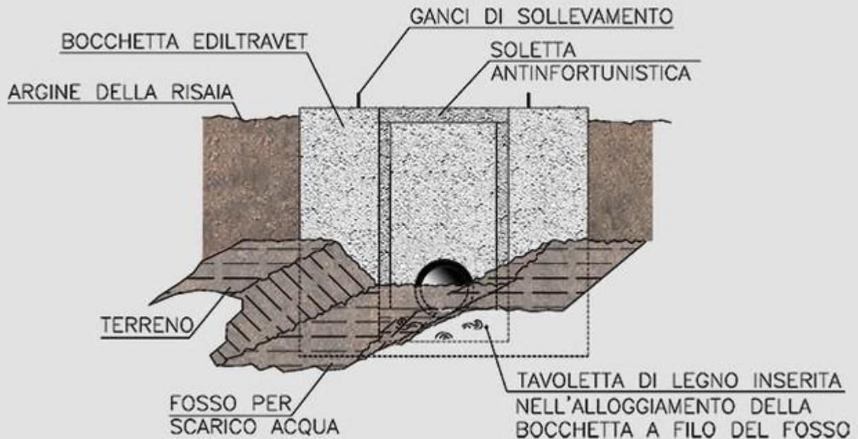
Il tubo di scarico deve essere inserito nella bocchetta dopo averlo dotato di guarnizione.
